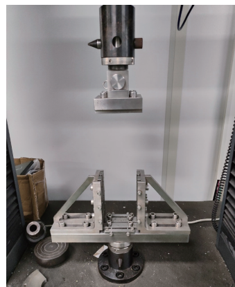
图 2 压缩剩余强度测试装置
